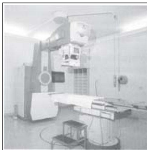
Figura 12 - Aparelho de radioterapia emite radiação gama de átomos de cobalto radioativo
