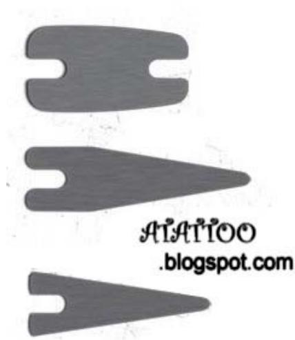
As molas são os componentes os mais importantes em uma máquina de tatuagem. Conhecidas também como Spring, as molas afetam quanta tensão uma máquina requer, a velocidade de funcionamento, e o comprimento do curso. Aço lustrado e aço moderado são boas escolhas de material para fabricação de molas para máquinas de tattoo. Ambos dispõe de dureza e resistência elevada, evitando a fadiga da máquina.
