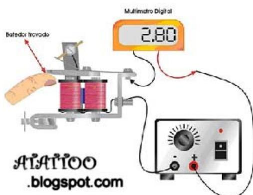
É aconselhável que este teste não ultrapasse 15 segundos, pois se sua fonte não suportar a amperagem da máquina ela pode esquentar demais com risco de ser danificada desnecessariamente.
