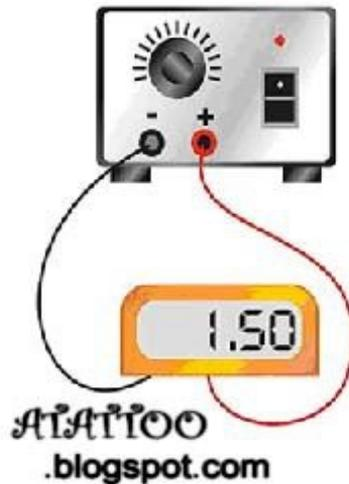
Gire o botão deslizante da fonte de alimentação e verifique se a voltagem mostrada pelo multímetro é igual à voltagem mostrada na escala da fonte. Este teste é apenas para termos uma porcentagem diferencial da fonte de alimentação, não sendo muito importante na prática.
